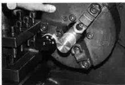
旋盤加工時に、インプロセスでの刻印を可能にしたマーキングシステムの例。採用したユーザーでは社内の「設備改善賞」を受賞したという。
