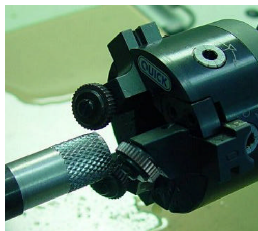
写真7 切削加工中のSTRタイプ
