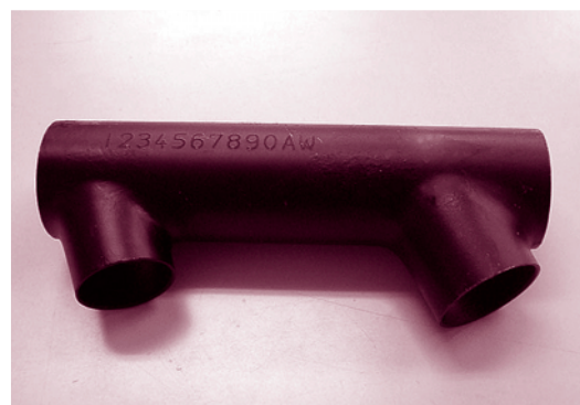
写真6 自転車車体へのマーキング例
