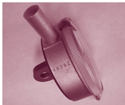
写真4 ダイアルゲージへのマーキング例
