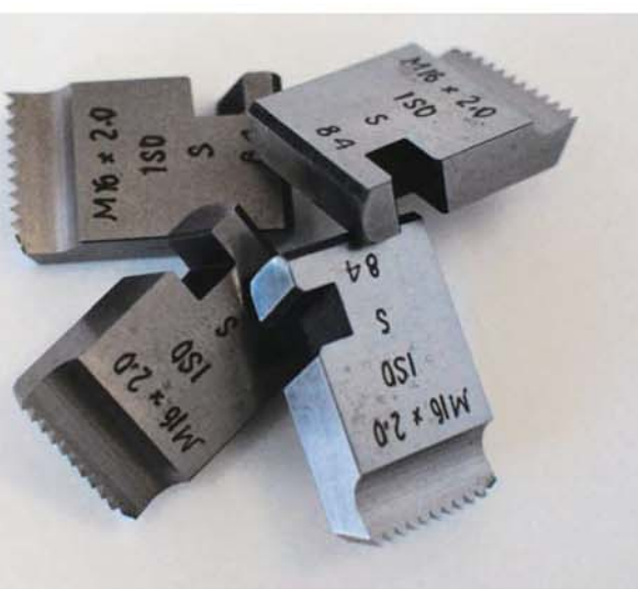
ネジ切り用のチェーザーも扱う。ヒアリングを基に顧客の要望に対応
